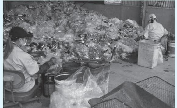
回収されたガラスびんのフタなどを手作業で外します
