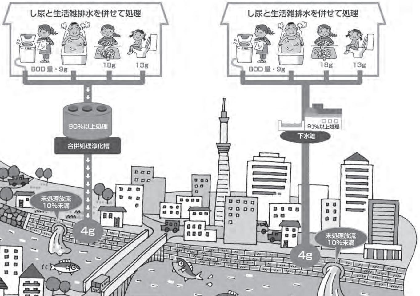
①くみ取り・②単独処理浄化槽と比べ、③合併処理浄化槽・④農業集落排水・⑤公共下水道は、川や海に流れ込む汚れの量を約1/8に減らすことができます。次世代の水環境のため、③～⑤の方法を利用しましょう。
