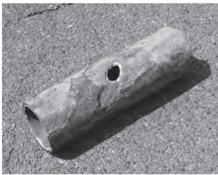
▲穴が開いた金属製の水道管。金属製でも老朽化すると穴が開き漏水します。
